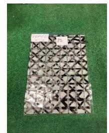
**24. Géogrille Texgrid CV200/200. (Carbone) Renforcement d'un revêtement routier**
