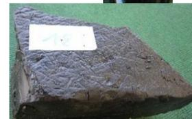
**19. Fabrication enrobé. Fibres de renforcement « Polymère PVC »**
